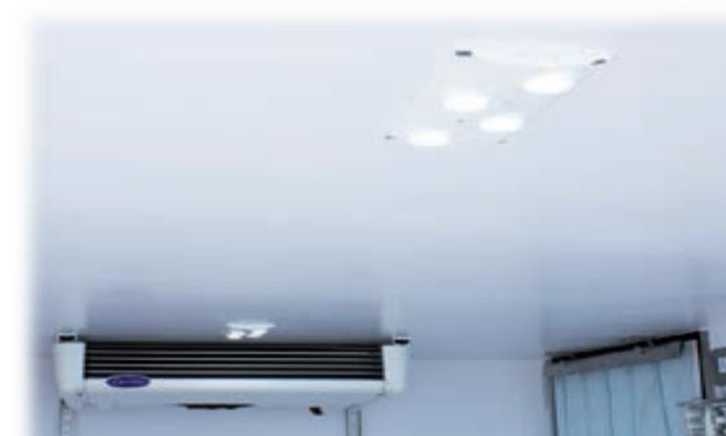
Світлодіодний світильник з перемикачем всередині кабіни
