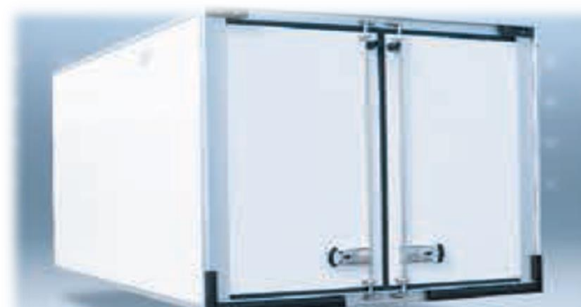
Композитні панелі (харчовий гелеобразний шар - полієфір - поліуретан), оснащені алюмінієвими вставками
